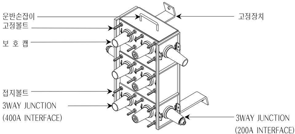
1. 그림과 같이 접속함에 고정장치를 주어진 너트를 이용하여 부착한다. 전주에 암타이 및 락크밴드를 조립한 후 접속함 고정밴드의 고정홈 위치에 맞게 벌려 놓는다.
